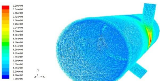
شکل ۱۱: کانتور جریان گرمای سطحی ( W/m^2 ) در فشار هوای ورودی ۱۲ بار
