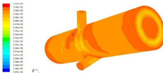
شکل ۸: کانتور دما (K) در فشار هوای ورودی ۱ بار
