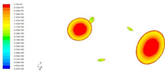
شکل ۵: کانتور سرعت‌های مماسی (m/s) در فشار هوای ورودی بار ۱۲
